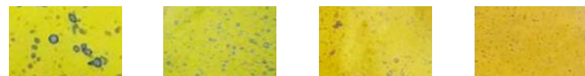
人工喷雾 大田机1.5m高度 大田机2m高度 弥雾机2m高度
